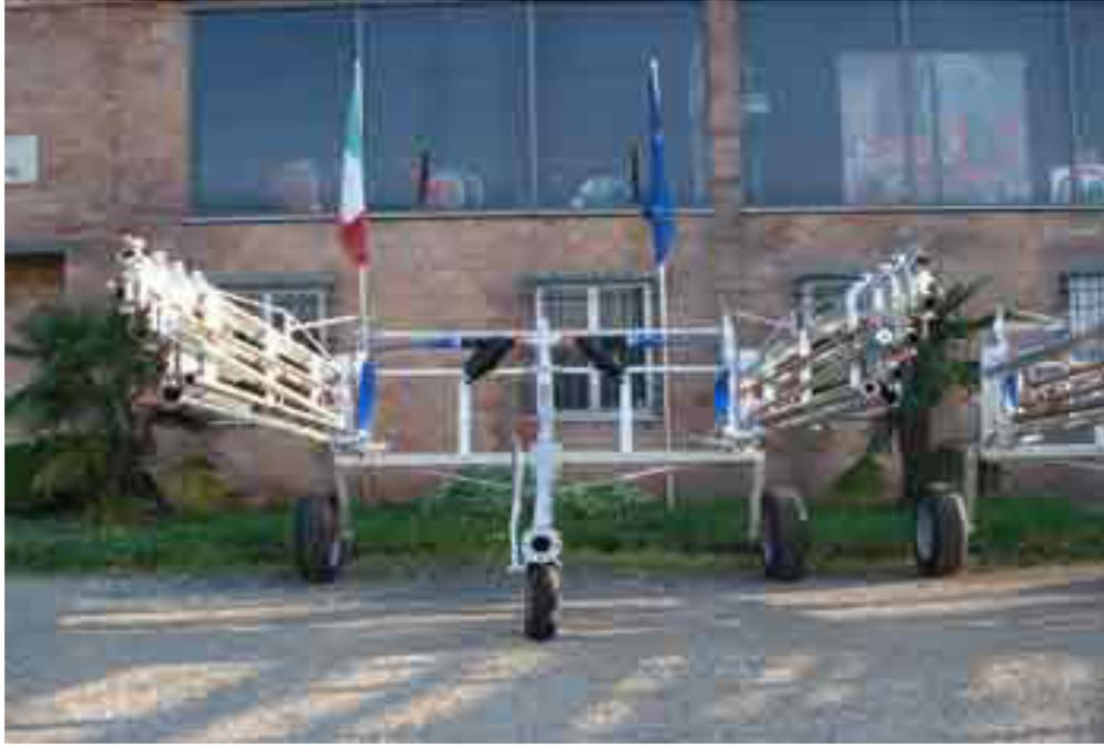
**"Three minutes"** è l' innovativa ALA telescopica progettata e realizzata da ORMA. Robusta e maneggevole, si apre o si chiude in meno di tre minuti. Tempi rapidi di preparazione, massima sicurezza e assenza di fatica fisica per l'utilizzatore del modello largo 36 m. in grado di irrigare una fascia di 46/48 mt.
